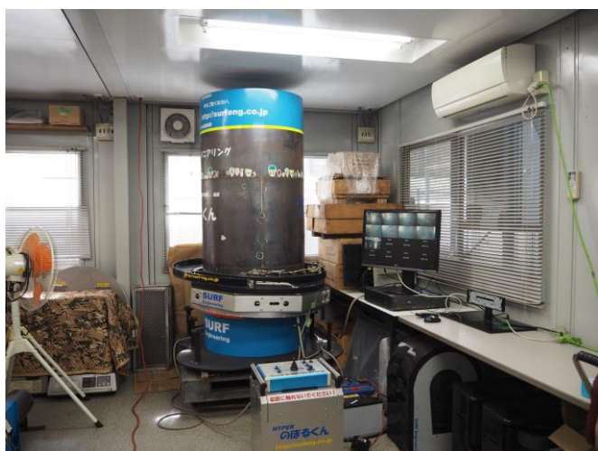
社内にある、管外面検査用昇降ロボット『のぼるくん』の現物
