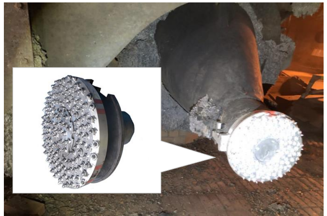
出銃口（溶銃の排出口）面を効率的に平滑化し作業効率をあげるマッドガン用ビット
