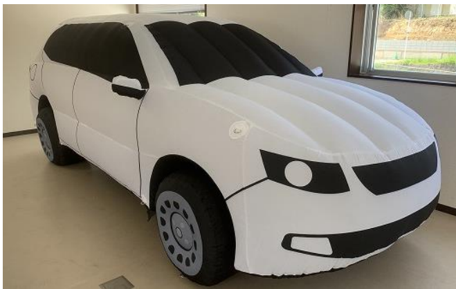
エア素材で作られた、衝突実験用の車両（自動車）ダミー。わずか5分で設営できる
