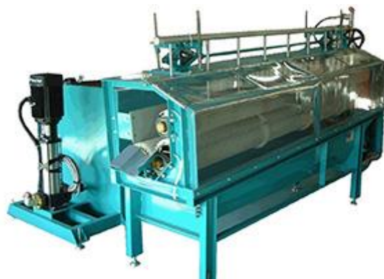
「大根洗浄機」中には見える筒状のプランが大根を受け止め、回転させながら洗う形
