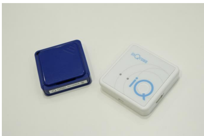
InQrossで利用される小型無線機「ロケタグ」と「ヒトタグ・モノタグ」 BLUETUSの技術も活かされた、屋内での動作をえる化する装置だ
