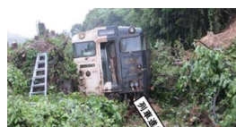
▲線路脇の斜面が崩壊し、列車が脱線(H26.6豪雨)
