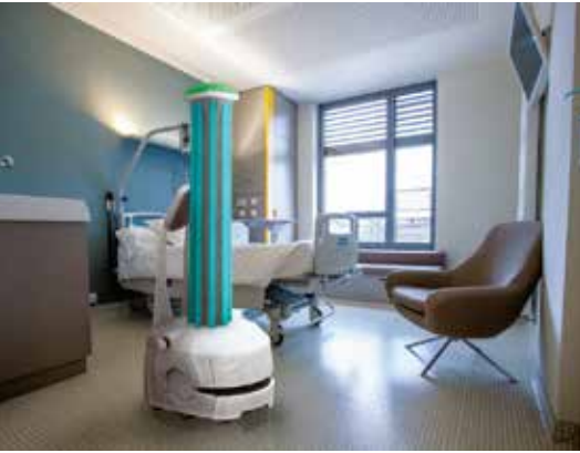
モバイルロボットがUVC（紫外線）光を自動で照射して、清掃員の安全確保や労働力の確保といった課題を解決
