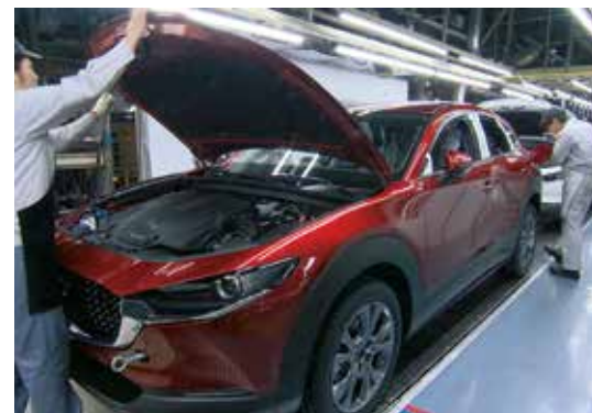
1ライン1車種ではなく多彩な車種が流れているのが特徴。少ない設備でローコスト、効率アップを図っている
